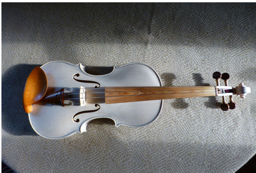
So sieht sie aus, die Wundergeige: Ein noch unlackiertes Instrument, gebaut von Boris Haug (Wilhelm-Geigenbau AG), das Griffbrett gepresst aus Fichte. zvg
